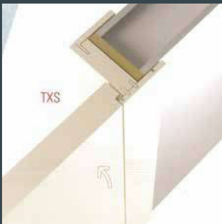
Particolare sezione porta Touch
